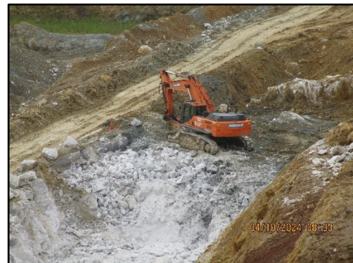
ภาพที่ 2.5 การนำ Hydraulic Breaker ติดรถ Back Hoe ใช้ในการทำเหมือง
