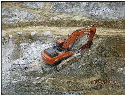
ภาพที่ 2.5 การนำ Hydraulic Breaker ติดรถ Back Hoe ใช้ในการทำเหมือง
