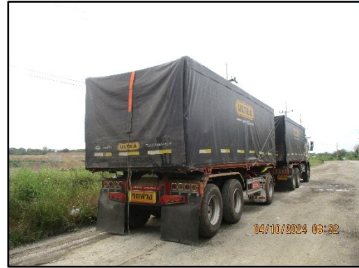
ภาพที่ 2.13 ผ้าใบปิดคลุมกระบะรถบรรทุกที่ขนส่งแร่ออกนอกพื้นที่โครงการ
