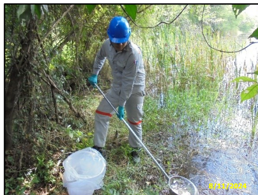
ภาพที่ 3.18 การตรวจวัดคุณภาพน้ำ ในบ่อดักตะกอน
